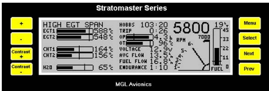
L’affichage ci-dessus est actif sauf lorsque l’on utilise une des fonctions accessibles à travers le système de menus. C’est l’affichage que vous verrez au sol ou en vol.
