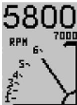
Le Stratomaster E2 comporte un compte-tours pouvant être adapté à une grande variété de moteurs. Vous devez renseigner le nombre d'impulsions pour 10 t/mn dans la section "SENDER SETUP" du menu "DEVICE SETUP".
