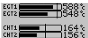
Le module d'acquisition RDAC a quatre canaux pour thermocouple. Ils peuvent être utilisés pour des sondes d'échappement EGT (exhaust gas temperature) ou des sondes de tête de cylindre CHT (cylinder head probes) (en général sur les bougies).
