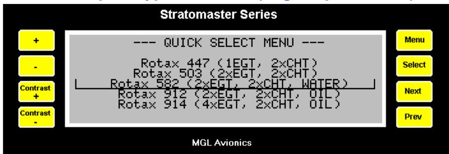
Ce menu permet de sélectionner rapidement un type de moteur pour votre Stratomaster E2. Cette sélection prérègle beaucoup des paramètres programmables aux valeurs recommandées pour le moteur sélectionné. Les types de moteur proposés doivent être considérés comme des exemples. Si votre moteur n'est pas dans la liste, choisir le type s'en rapprochant le plus, puis utiliser le menu "Engine detail setup" pour modifier les paramètres.
