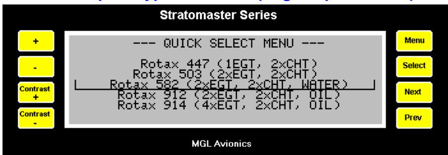
Ce menu permet de sélectionner rapidement un type de moteur pour votre Stratmaster E2. Cette sélection prérégle beaucoup des paramètres programmables aux valeurs recommandées pour le moteur sélectionné. Les types de moteur proposés doivent être considérés comme des exemples. Si votre moteur n'est pas dans la liste, choisir le type s'en rapprochant le plus, puis utiliser le menu "SENDER SETUP MENU" et "ALARM SETUP MENU" pour modifier les paramètres.
